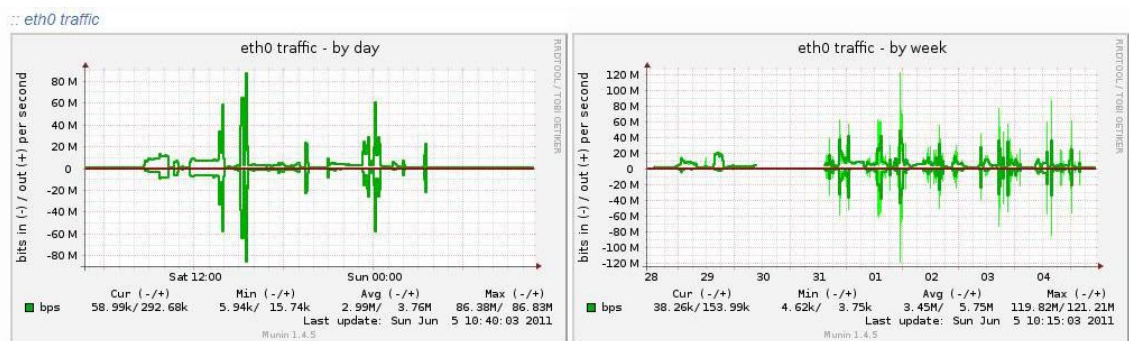
Figura 3.18 Uso de la interfaz de red eth0 en el servidor.
